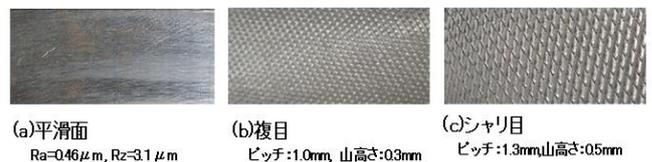
図 4 やすりと平滑面の概要
