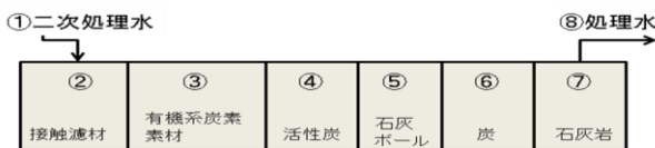
図 1 高知工科大学四万十川方式(三次処理)浄化槽のモデル
