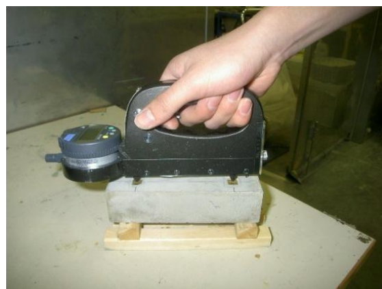
写真 - 1 膨張・収縮量の測定
