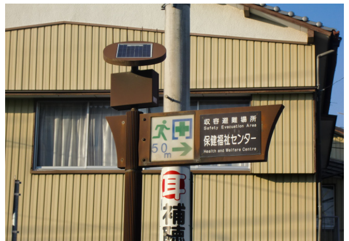
写真 2.1 太陽光パネルのついた案内標識
