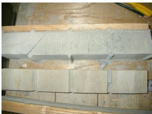
図-12凹式の破壊後
