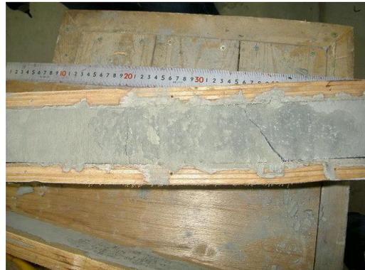
図-6 風車式の破壊後
