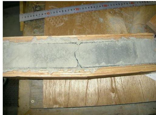
図-10凸式の破壊
