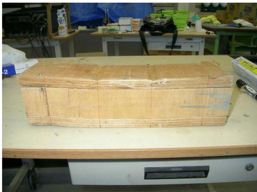
図-4パターンA破壊後
