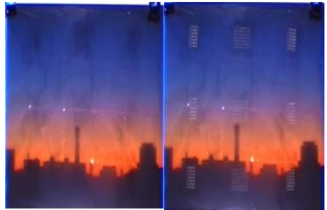
写真1 盗撮防止装置を作動させていない状態でビデオ撮影をした映像(左)盗撮防止装置を作動させた状態でスクリーンのビデオ撮影をした映像(右)
