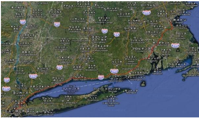
地図-4 アメリカ ボストンからニューヨーク 6) 総距離370km, 平野部98.6%山間部2.4% 橋梁6.5%トンネル0%
