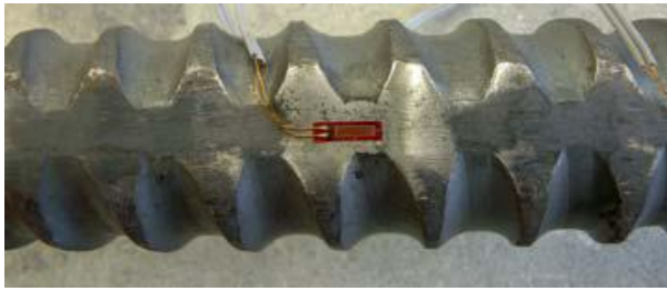
図-1 使用した鉄筋とひずみゲージ
