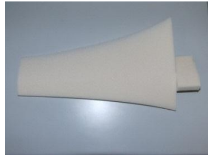
図3 ブレード図(発泡スチロール)
