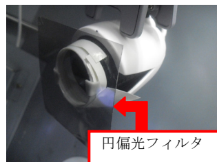
図 3 使用する Web カメラ
