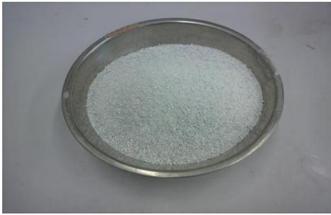
写真-1 本研究で用いた石灰石砕砂
