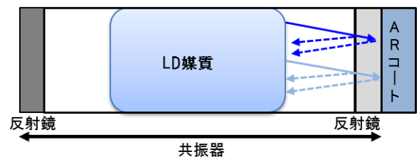
図 2. AR コート付き LD の仕組み
