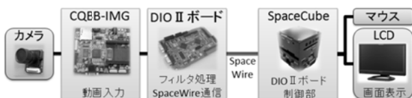
図 2 クライアント制御システム
