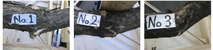
図4-6 曲げ試験における各丸太の破壊形態
