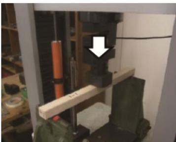
図4-4 小試験体曲げ試験 写真
