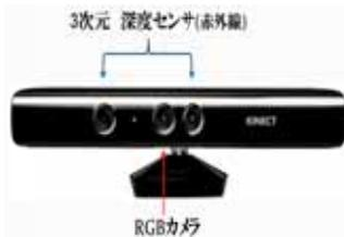
図 1. Kinect センサ
