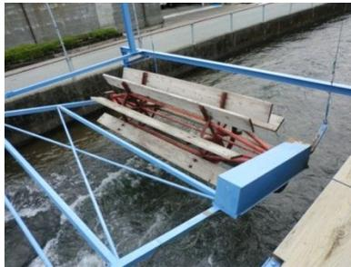
図 1 マイクロ水力発電機
