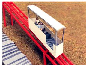
さらに今回のケーブルカーは、水源を地下タンクに貯蔵された生活排水と雨水とすることで、運行のために新たなエネルギー消費を必要としない。また、地下タンクに貯蔵された生活排水と雨水の貯蔵量を日常的に目視することができる装置を計画する。ケーブルカーの動力源となる生活排水と雨水の貯蔵が可視化されることで、エネルギー消費感覚の喪失を防ぐ。
