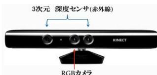
図1. Kinect センサ
