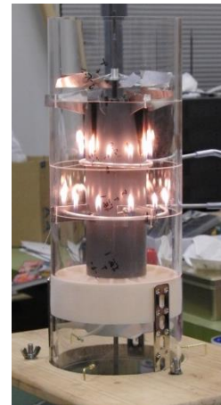
図 3 運転中の卓上ガスタービン
