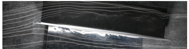
図4 平板翼 取り付け角 8.39度の時の流れ
