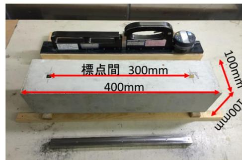
写真-1 供試体及び試験器具
