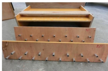
写真-3 分離コンクリート判定の為の障害物
