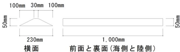
図3-2 堤防模型の立面図
