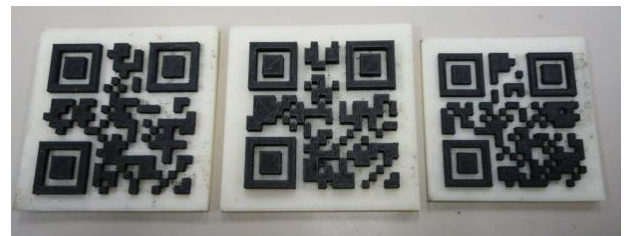
図2 実際にプリントアウトした 3次元QRコード (左から「安居 新」「電子 安居 新」 「工科大 綿森研」)
