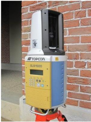
図-2.1 LiDAR の外観
