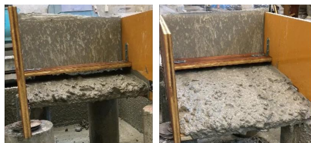
写真-5 空気量 11.8%，スランプフロー575×590 の水平距離による比較実験
