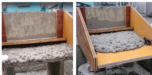
写真-4 空気量 3.7%，スランプフロー550×565 の水平距離による比較実験
