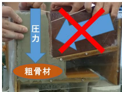
写真-2 パーツを取り付けた「L字型随時試験器」
