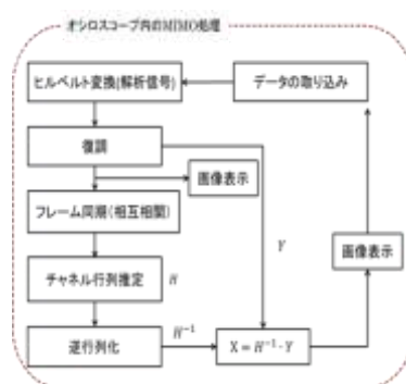
図 3 組み込んだ MIMO 処理の流れ
