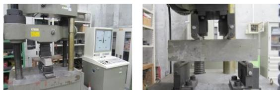
図-14 曲げ試験機と共試体
