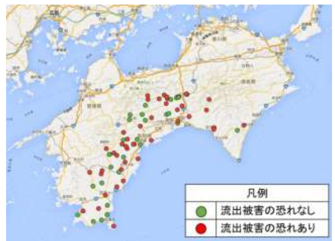
図 8-1. 桁流出被害予測のマップ
