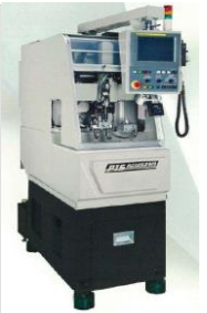
図2 精密 CNC 旋盤の転倒評価 写真1 精密 CNC 旋盤 精密 CNC 旋盤 h=97cm b=27.5cm
