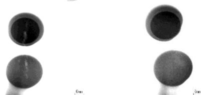
図5. X線写真比較 (左: 従来の型 右: 新たな型)
