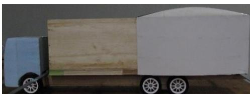
図 3 空力低減装置装着時
