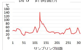
図 5 燃焼器内温度
