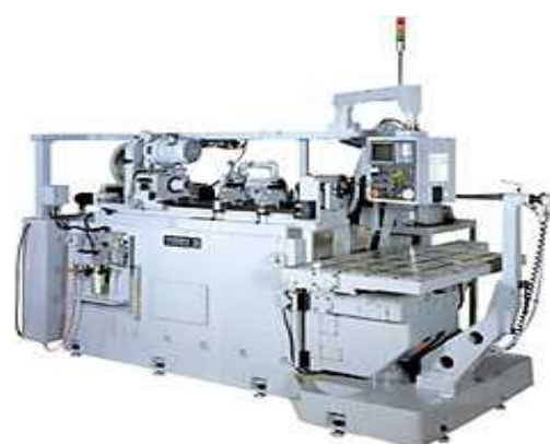
図1-4 ガンドリルマシン([1]ミロク公表資料より)
