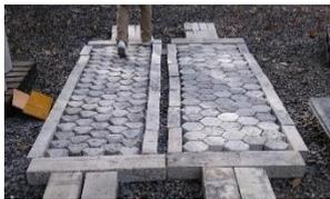
図-6 設置したブロック(左:噛合せ型、右:六角錐型)
