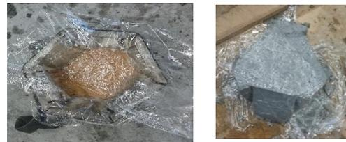
図-3 ラップフィルムを用いた即時脱型(左:充填前型枠、右:脱型後ブロック)
