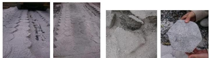
図-11 端部拘束なし走行後(左:六角錐型、右:噛合せ型)
