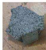
図-4 隙間が多く残ったブロック
