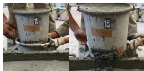
写真-3 ゲート改良前試験器 (外側カバーを下げながら外して内部容器の出口からコンクリートが流れる形式)
