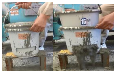
写真-4 ゲートを改良した試験器 (内側容器を持ち上げながら外し、外部容器の出口からコンクリートが流す形式)
