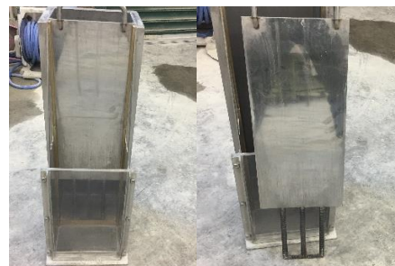
写真-1 ボックス試験・障害物 R 2 (鉄筋 3 本)
