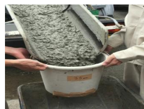
写真-2 作業性を考えた新型試験器
