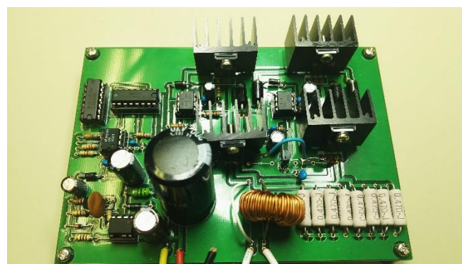
図 3 プリント基板に配線したインバータ回路
