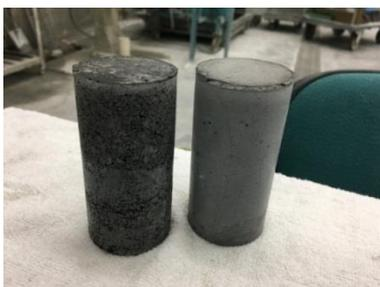
図-1 小さい単位水量による木灰コンクリートの充填不良（左；右は充填されたもの）
