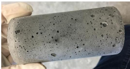
図-4 高性能AE減水剤を添加した場合の硬化後の表面気泡
