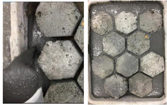
写真-5 飛灰を用いた目地材の施工試験の様子
