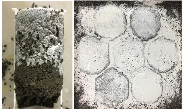
写真-3 消石灰+高炉スラグの混和水散水後の断面と表面
