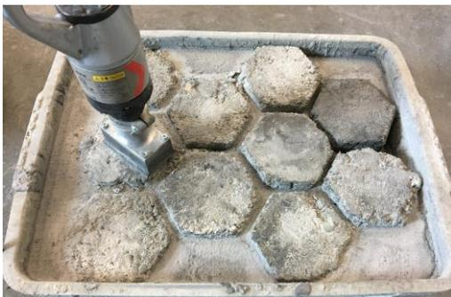
写真-1 壁打振動機による簡易振動試験の様子
