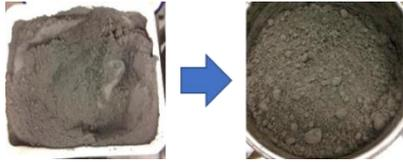
図-1 未加湿飛灰と加湿処理と同等の質量比 25%の水を吸水させて 24 時間後の後の状態
