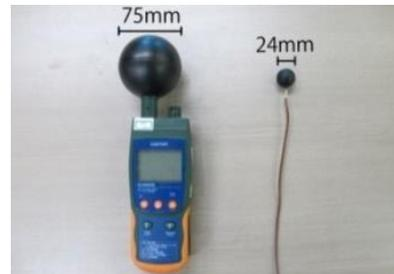
写真 1 WBGT 計（75 mmグローブ温度計使用）と小型グローブ温度計
