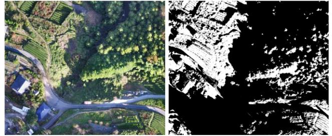
図-5 Shadow シミュレーション結果
