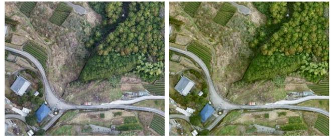
図-16 色温度の補正結果: 曇り (左: 補正前 右: 補正後)
