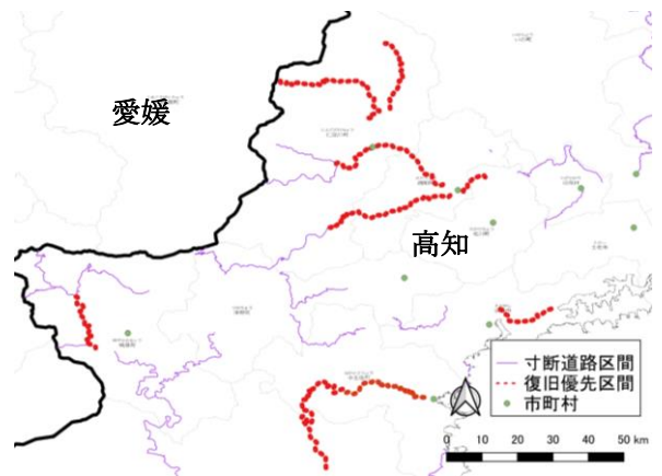
図-4 豪雨時における実際の復旧優先区間
