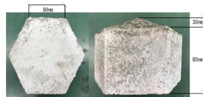
図-1 舗装用木灰コンクリートブロック形状と寸法
