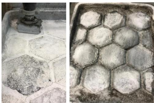
写真-1 簡易振動試験と散水後のブロック配列の様子
