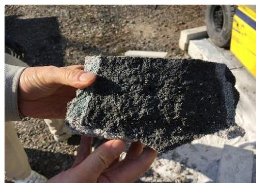
写真-5 ブロックと目地材の一体化と割れ
