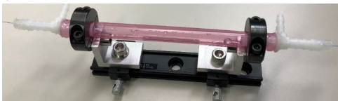
図2 センサを流路に導入するための機構
