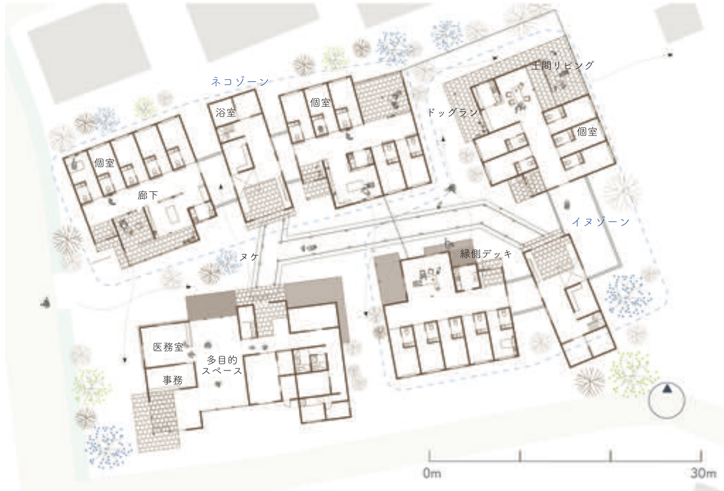
図4. 配置図兼1階平面図
