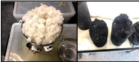
写真-1 紙繊維添加の木灰コンクリート断面
