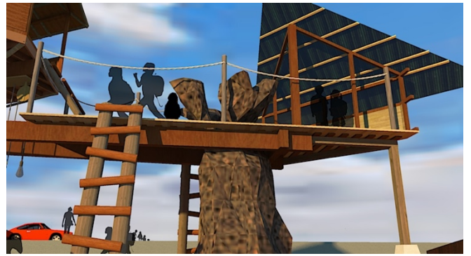
図12 カイヅカイブキを土台とした部分 (構造がわかりやすいように土台樹木上部は写して いない)
