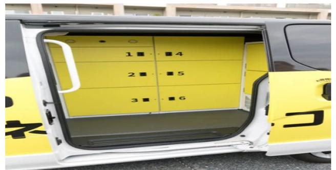
図5 宅配ロッカーが搭載された自動運転車両【14】
