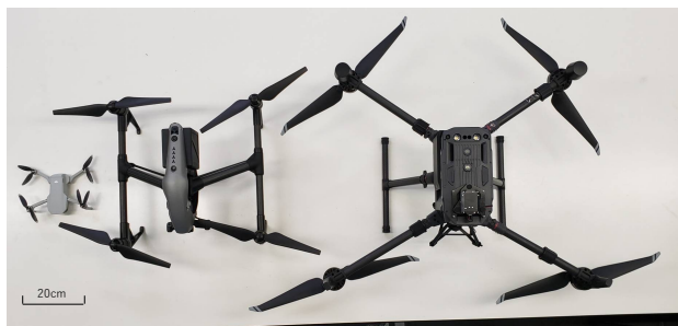
図-3 観測で使用した UAV (左から mini2, inspire2, MATRICE300)
